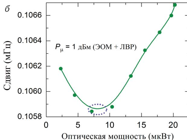
Сдвиг частоты только при ЧМ излучения ЛВР (а) и при двойной модуляции АМ + ЧМ (б)
