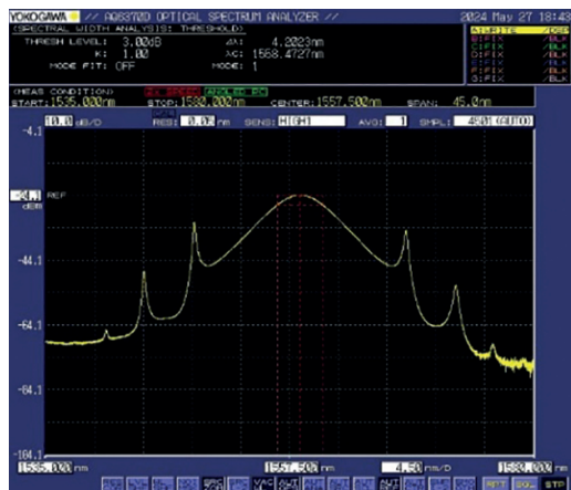
Рис. 3. Оптический спектр (слева) и осциллограмма следования импульсов (справа) на частоте 679 МГц
