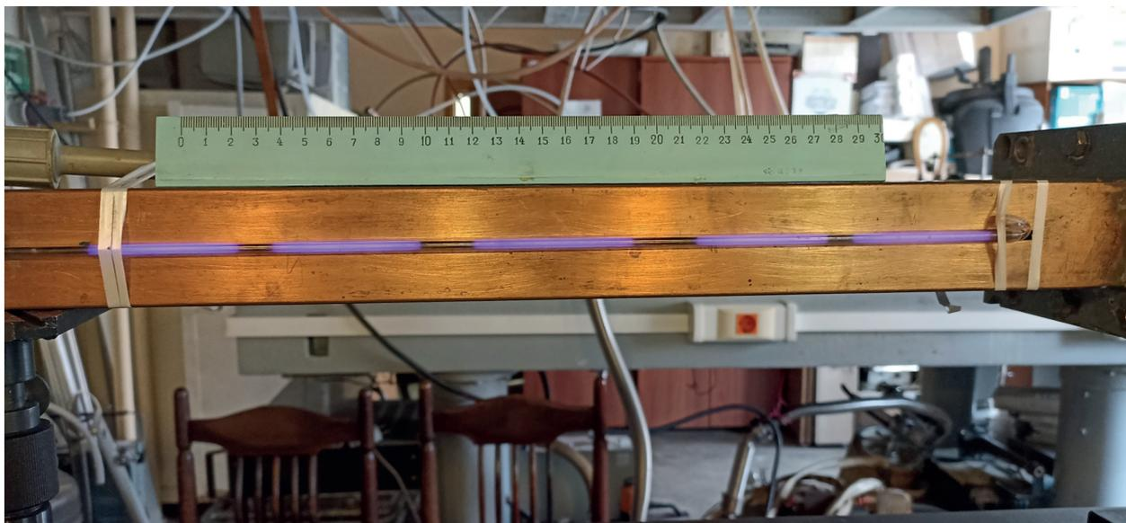
*Рис. 1.* Внешний вид газового разряда в волоконном световоде, расположенном в щели узкой стороны прямоугольного СВЧ-волновода. Свечение газа в световоде соответствует интерференционной картине СВЧ-волн, формирующейся в СВЧ-волноводе при отражении от закорачивающего поршня на выходе волновода
