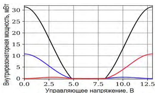
Рис. 3. Зависимость внутрирезонаторной мощности от управляющего напряжения на ЭОП: черная кривая – мощность на выходе ПОУ, синяя и красные кривые – мощности излучения, циркулирующего в пассивной петле по часовой стрелке и против. соответственно
