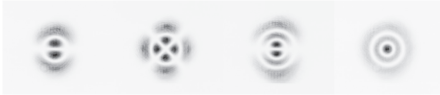
Рис. 1. Фотографии мод LG_{11} , LG_{21} , LG_{12} , LG_{02} (слева направо), возбужденных в эксперименте
